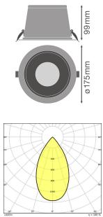
**Technische Daten Ledvance LED Downlight Biolux HCL Zigbee Gen 2 Aluminium Weiß 20W 2100lm 60D - 927-965 Abstimmbares Weiß | 175mm - Ausschnitt 160mm - IP20 - ZigBee**
